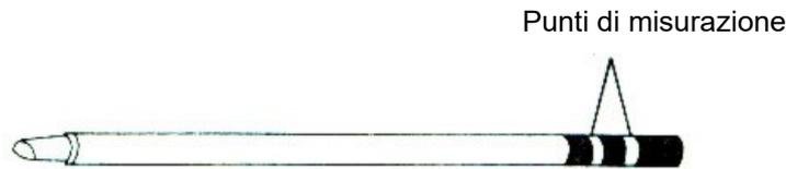
Per controllare che il connettore del saldatore non sia danneggiato, si dovrebbe misurare la resistenza tra il terzo polo del connettore e la punta del saldatore. Il valore non deve superare i 2  $\Omega$ . Se ciò accade, anche dopo aver pulito la punta di saldatura, allora vuol dire che la spina del connettore è difettosa e deve essere sostituita.
