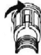
Sichern Sie den Stecker, indem Sie ihn im Uhrzeigersinn drehen.
