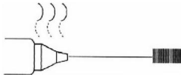
Die Reinigungsnadel wird ganz durch das Loch in die Düse geschoben.
