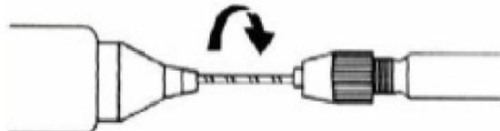
Stecken Sie den Reinigungsbohrer in das Düsenloch, indem Sie ihn im Uhrzeigersinn drehen.
