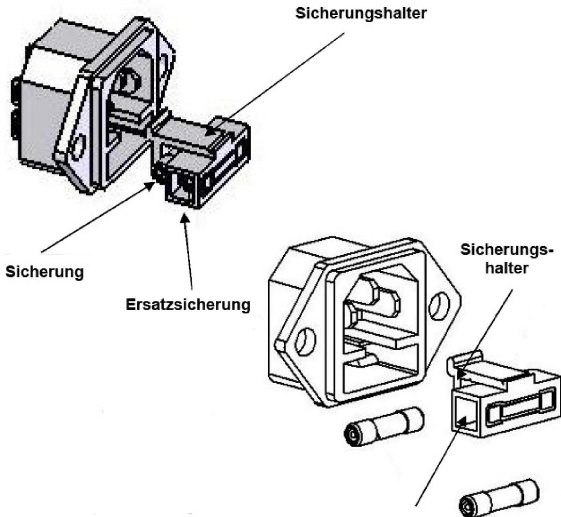
1. Benutzen Sie einen Schraubendreher, um den Sicherungshalter zu öffnen. Ziehen Sie den Sicherungshalter heraus.
