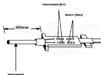
Bitte beachten Sie, dass die Abbildung die 936 A darstellt. Bei der 936 ist das Sensorkabel blau und weiß mit einer Wachsbeschichtung.
